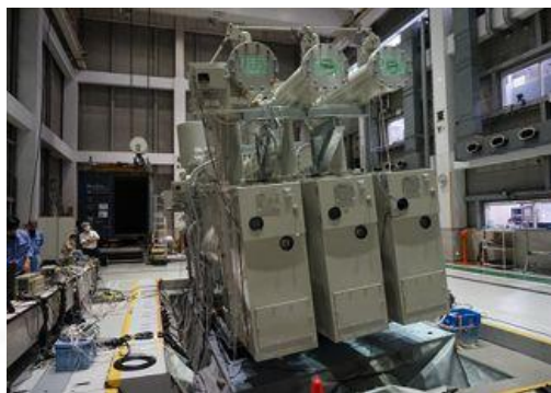
図 6. 300kV GIS 傾斜振動試験
