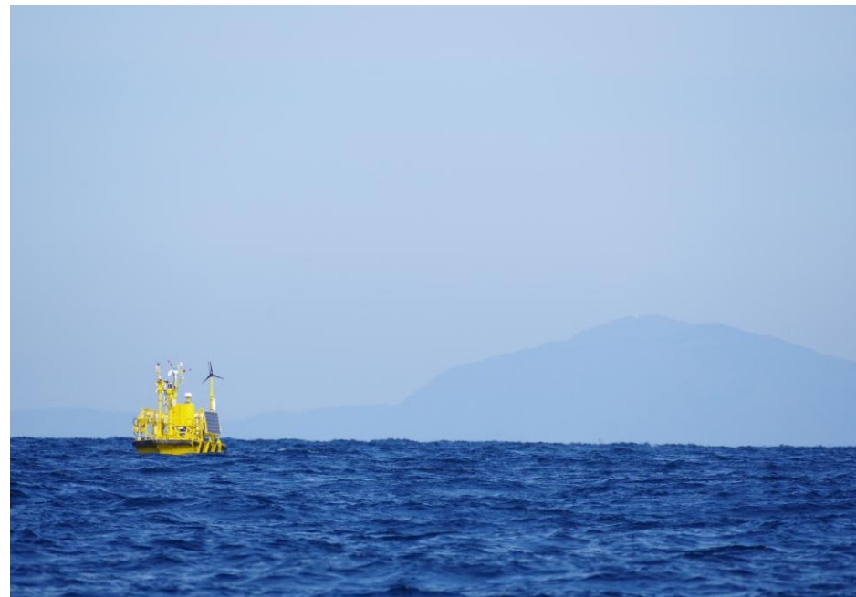
秋田県南部沖 フローティングライダーによる風況調査実施状況
