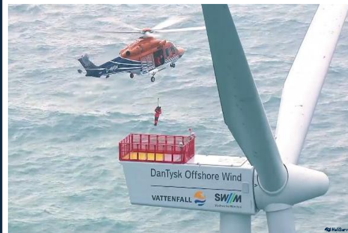
ヘリコプターによる洋上風車への人員降下 出典: HeliService International GmbH 公式動画から抜粋
