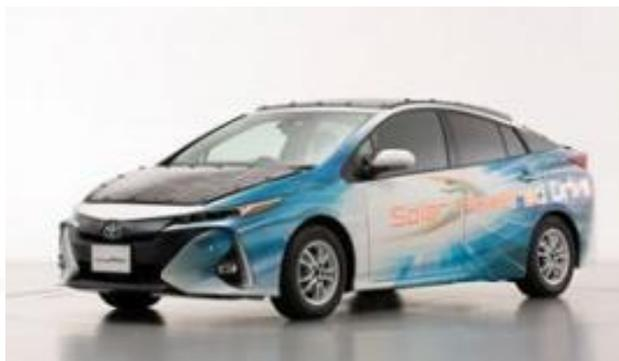
太陽光発電システム搭載自動車実証車両
