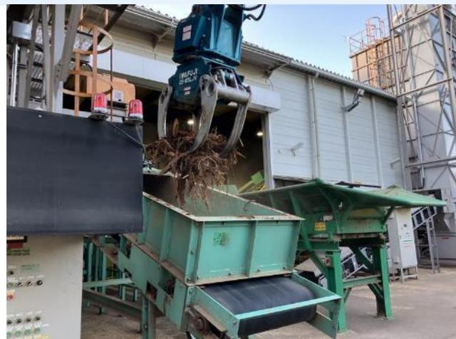
図2. バークを破碎機Bで破碎
