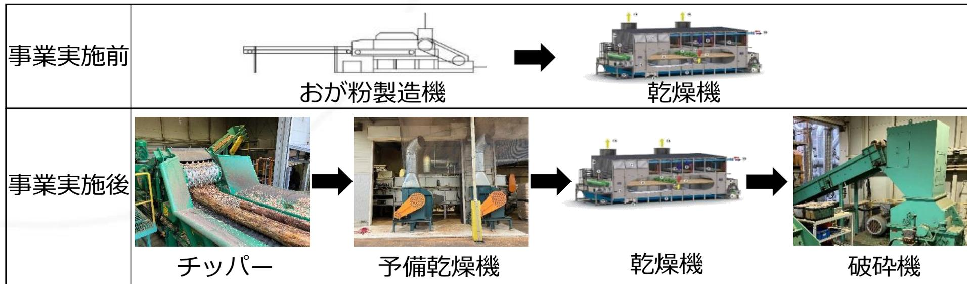
図13. 乾燥おが粉製造方法の新旧比較
