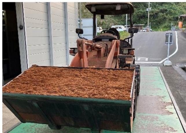
図3. バーク粉の比重測定
