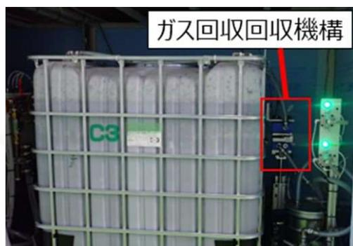
ガス回収回収機構
