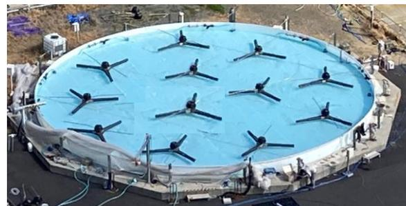
中規模オープン型培養装置(直径20m)
