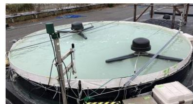
小規模オープン型培養装置(直径5m)
