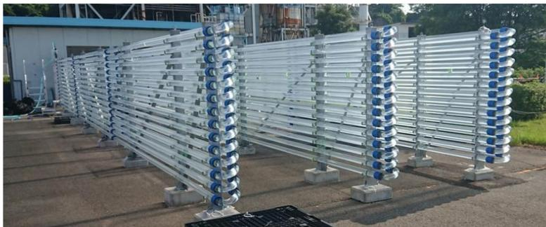
大規模クローズ型培養装置(南北方向) 3基
