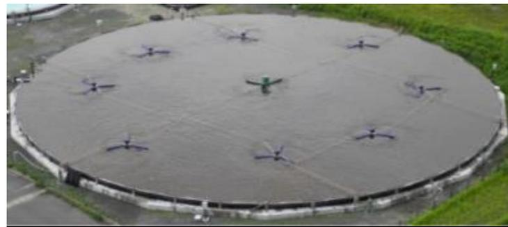
大規模オープン型培養装置(直径40m)
