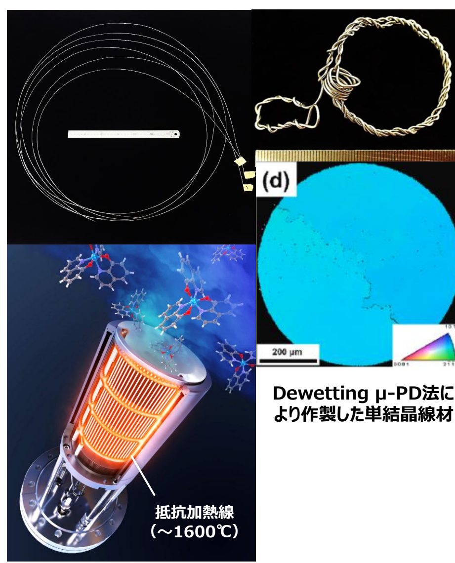
有機EL成膜に用いる真空蒸着セル用高効率・長寿命抵抗加熱線
