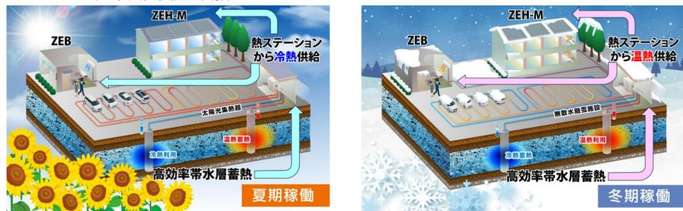
図 帯水層蓄熱を中心とした面的熱利用によるZEB及びZEH-Mの運用イメージ
