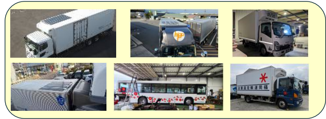
図3. 太陽光発電を設置した商用車の例
