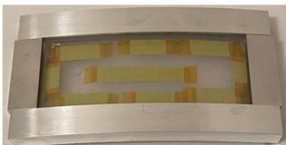
浸水試験14.5 h後のモジュール構造の外観
