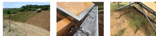
傾斜地設置型PVの地盤侵食保護に関する実証実験の状況
