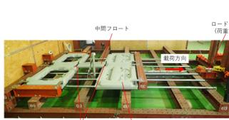
フロート-フロート間接合部の試験風景
