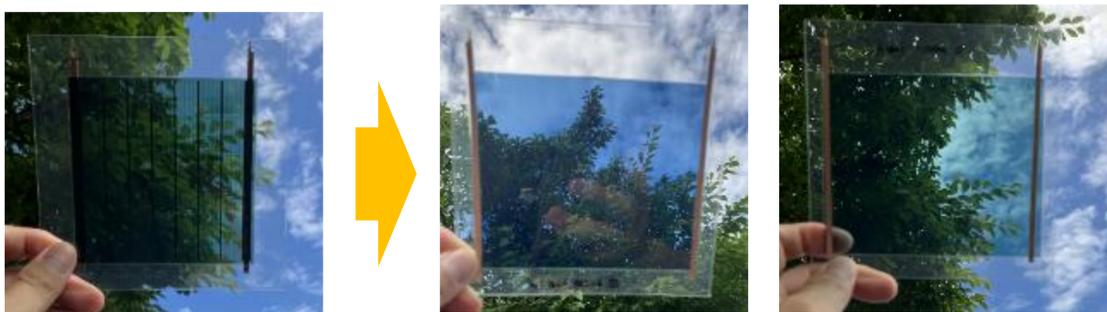
モジュールサイズ：100 mm x 100 mm, モジュール構成：ITO/ZnO/発電層/導電性ポリマー
