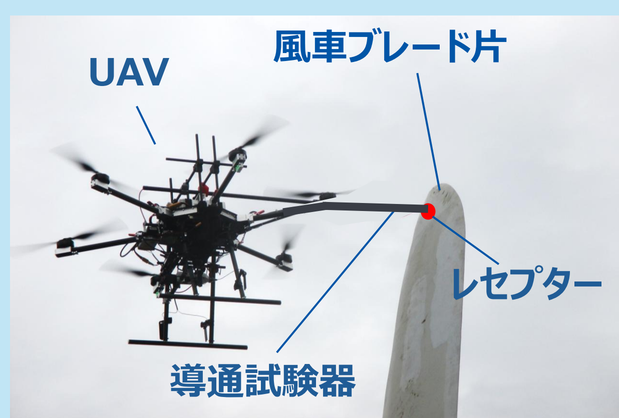
写真）風車ブレード片のレセプター部に対して自律飛行により専用端子を接触させる導通試験用UAV
