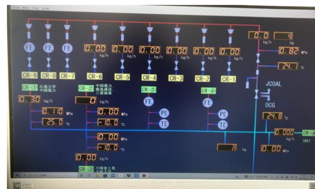
CO 2 遠隔監視モニター
