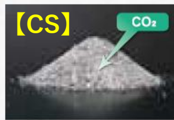
CO 2 固定再生細骨材 (50kg-CO 2 /ton 骨材)
