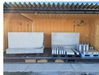
実大試験体の炭酸化養生
