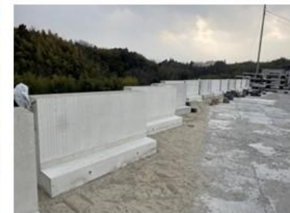
耐久性確認のための暴露実験
