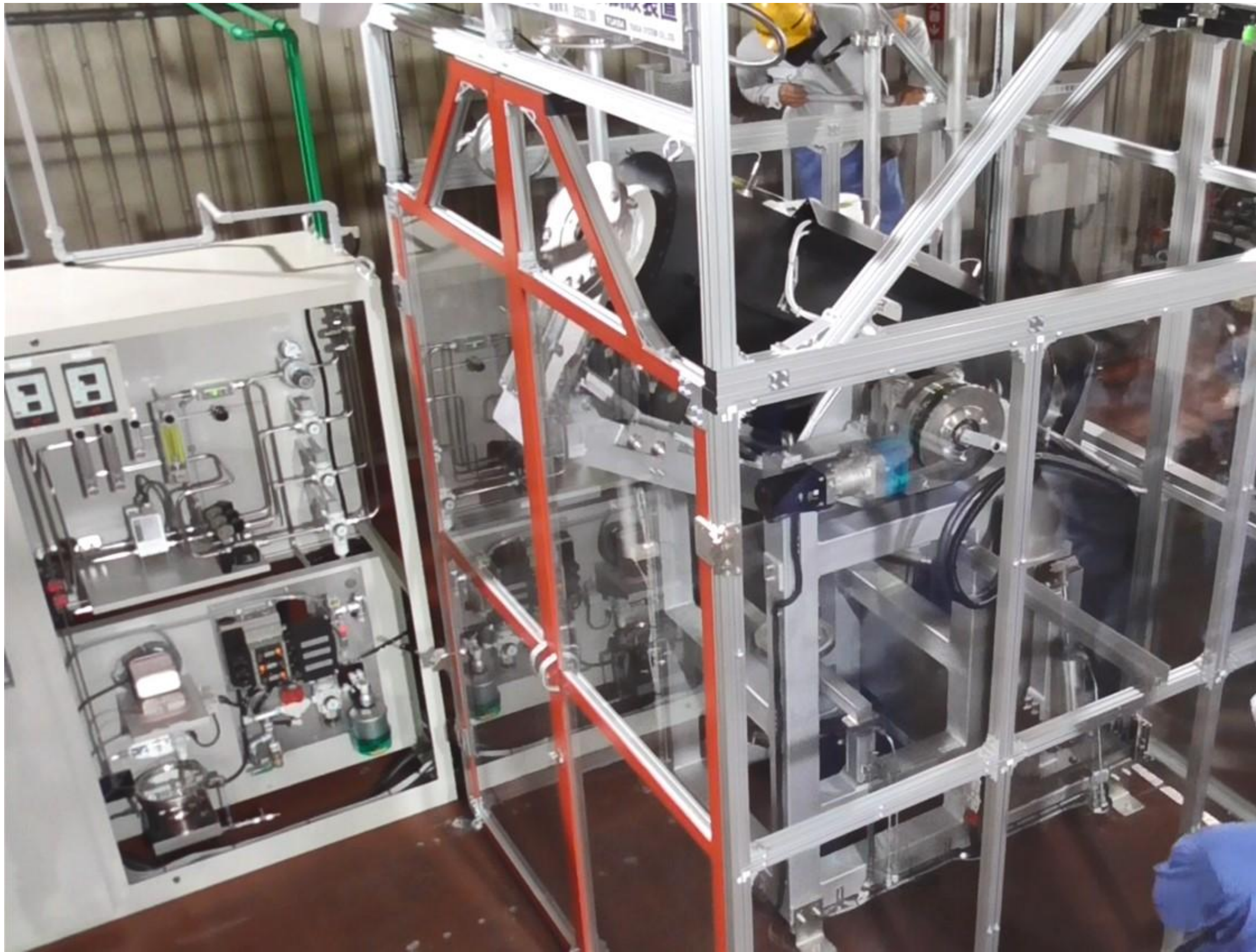
図3. ラボ炭酸化兼熱回収試験装置
