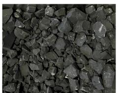
石灰石原料を人工石灰石で100%置換して電気炉で焼成したクリンカ
