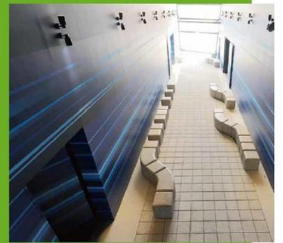
東京都板橋清掃工場やいぶきグリーンエネルギーバイオマス発電所から排出されるバイオマス由来のCO<sub>2</sub>を床板ブロックやベンチに吸収・固定させています。未来のコンクリートの提案です。
